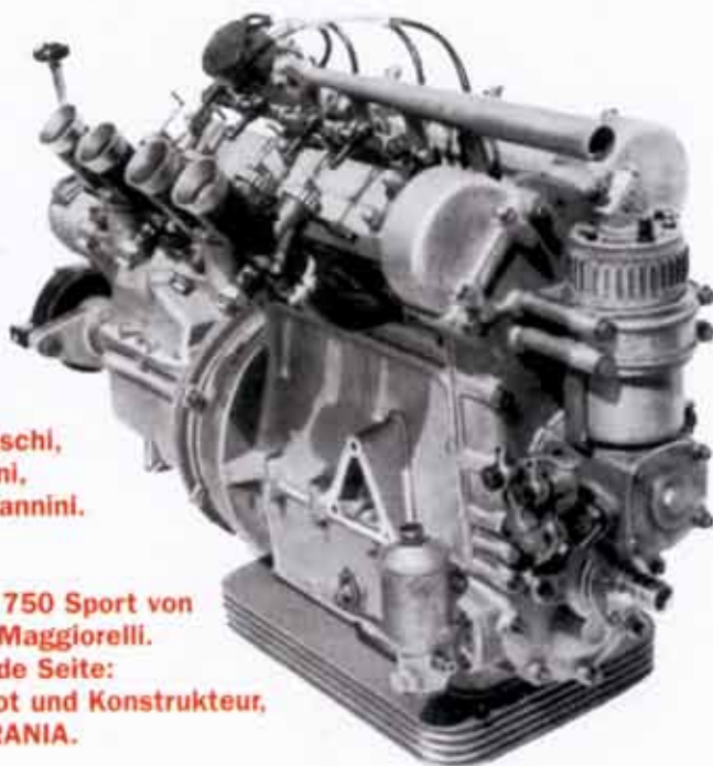
Pipi-feiner Motorenbau: der Gianni G2-Motor mit 4 Dell'Orto Motorradvergasern, 735 ccm, 60 PS/7.800 U/min.
