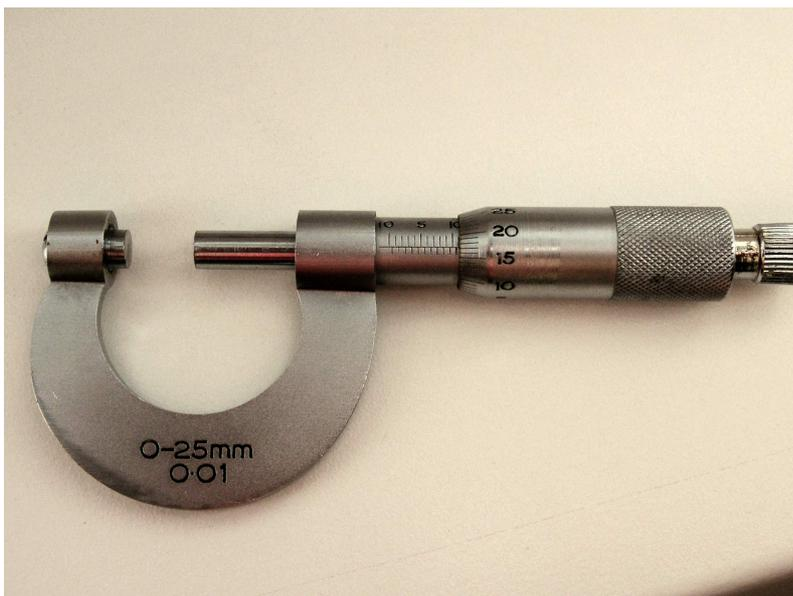
Kommen wir von der Theorie zur Praxis. Wie wir ein Lineal mit Zentimetereinteilung kennen, jeder Schüler besitzt ja ein Solches, verwendet man zum Abmessen kleinerer Abstände auch eine sogenannte „Mikrometerschraube“. Das ist ein schraubenförmiges Messgerät, eine Umdrehung der Schraube entspricht einem halben oder ganzen Millimeter, so dass man die Abstände ziemlich genau messen kann.
